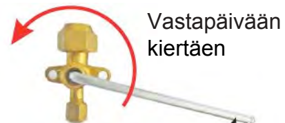
6. Irrota huoltoventtiilien hatut ja avaa huoltoventtiilit kuusiokoloavaimella kokonaan auki.
